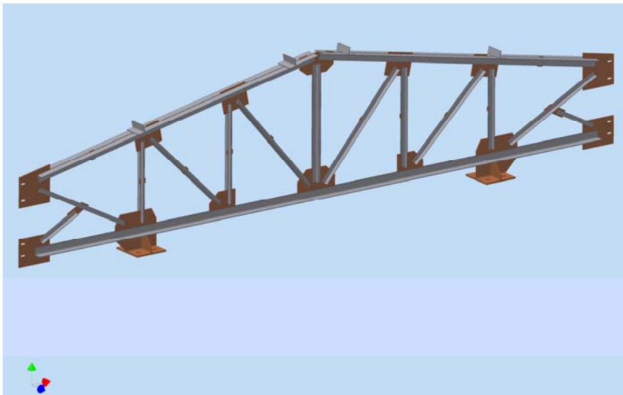
Рис. 1. Трехмерная модель фермы.
